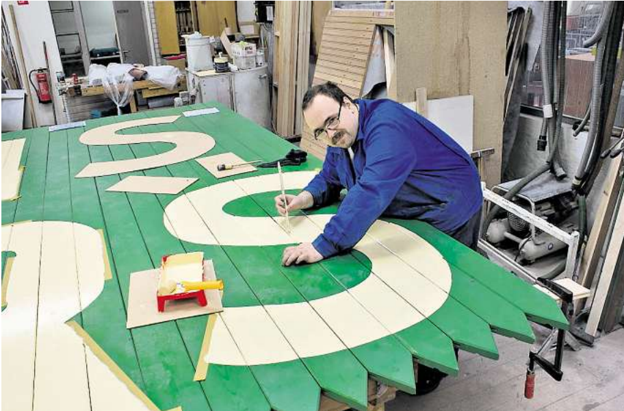
Die 700 Kilogramm schwere Holzkuppel wurde abgesägt und zu Boden geholt (Bild oben). In den angrenzenden Werkstätten des Vereins Bildung und Beruf wird der gesamte Turm saniert. Markus Wiese (unten) kümmert sich um die äußere Holzverkleidung.
